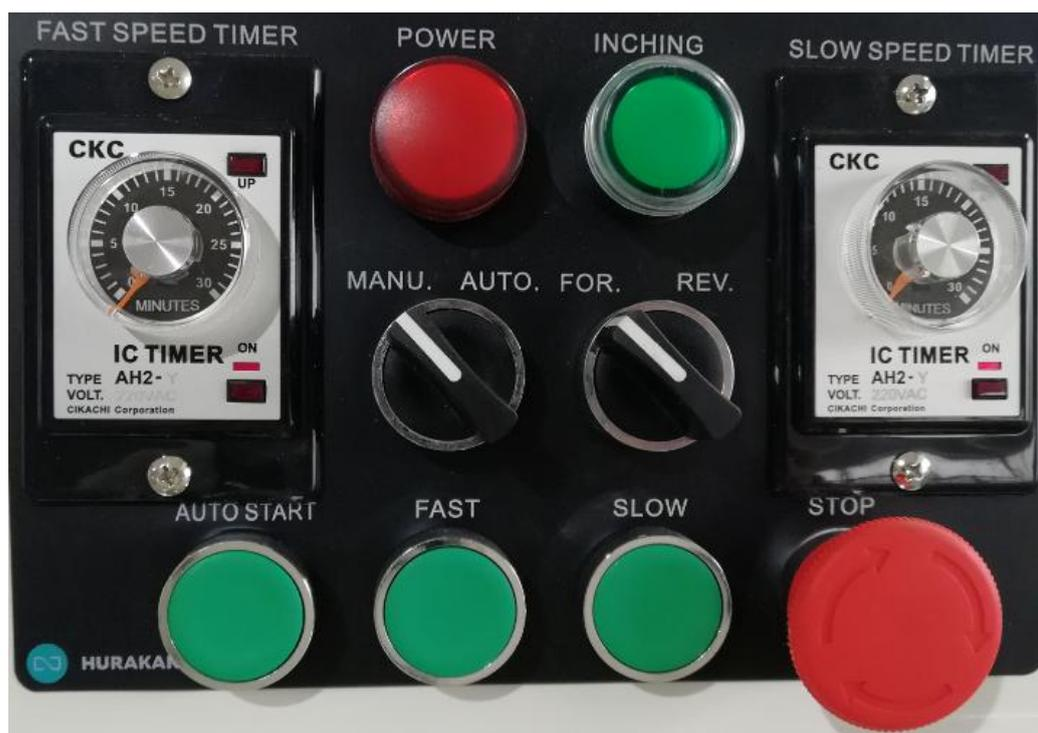
Fast speed timer – таймер автоматического режима работы на высокой скорости
