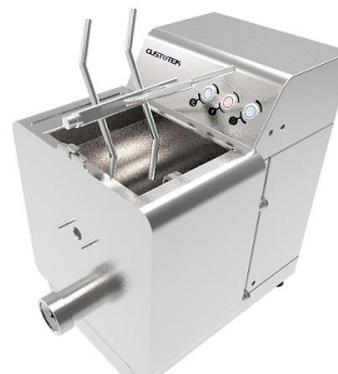
Открутить 4 болта фиксации танка для замеса теста на корпусе машины
