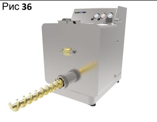
Открутить болты, фиксирующие пластину опоры роstra к танку замеса и далее извлечь пластину опоры роstra
