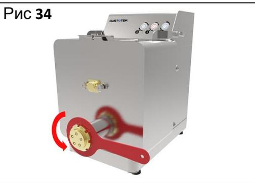
Извлечь насадку из камеры экструзии и незамедлительно расположить ее в контейнер, наполненный водой. Данное действие производится для облегчения последующей процедуры чистки.
